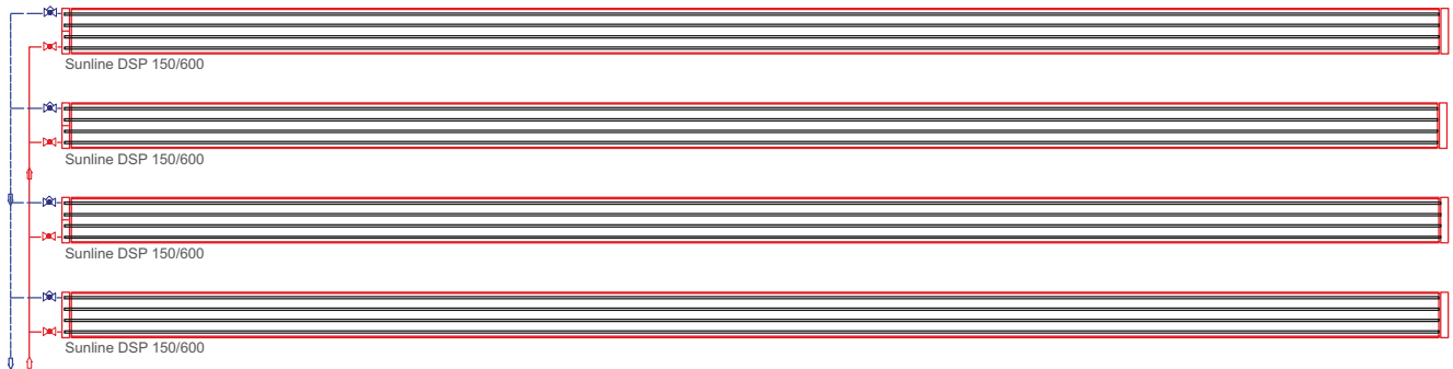
1. Einseitiger Anschluss mit Volumenstrom-Durchflussreglern
